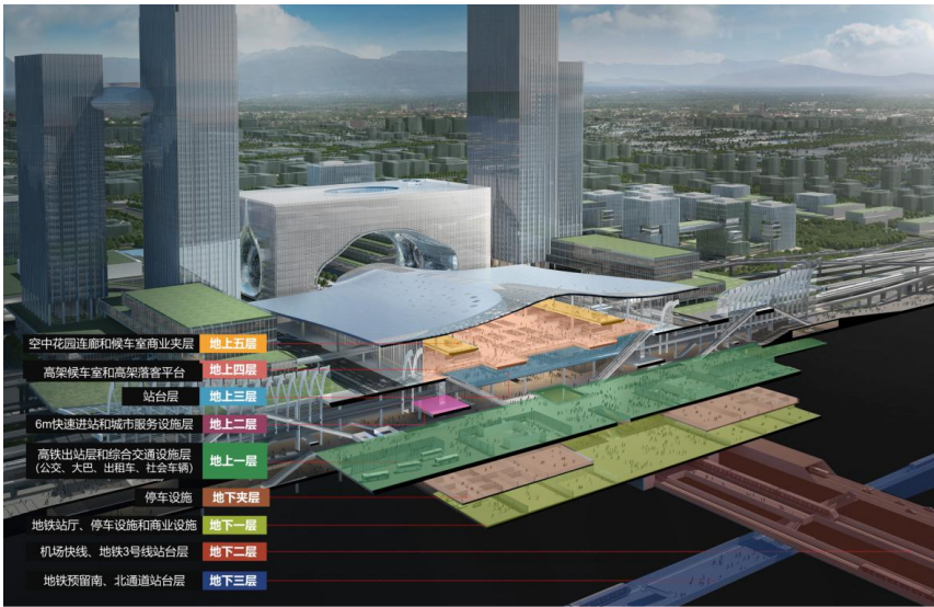
图 14-3 杭州西站站房各层功能图示
