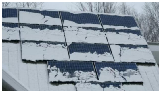
被大雪压毁的光伏组件
