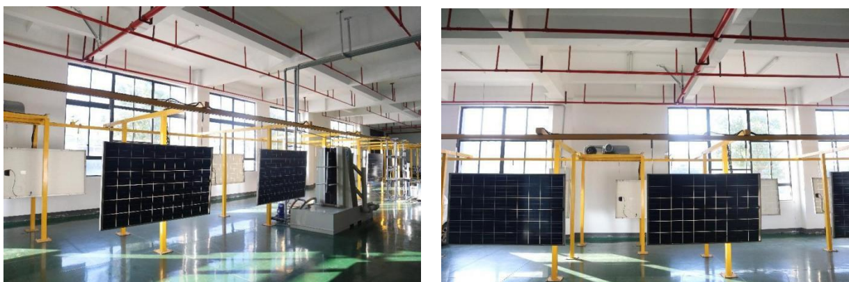
图 4.3 瑞赛环保退役光伏板发电效率检测
