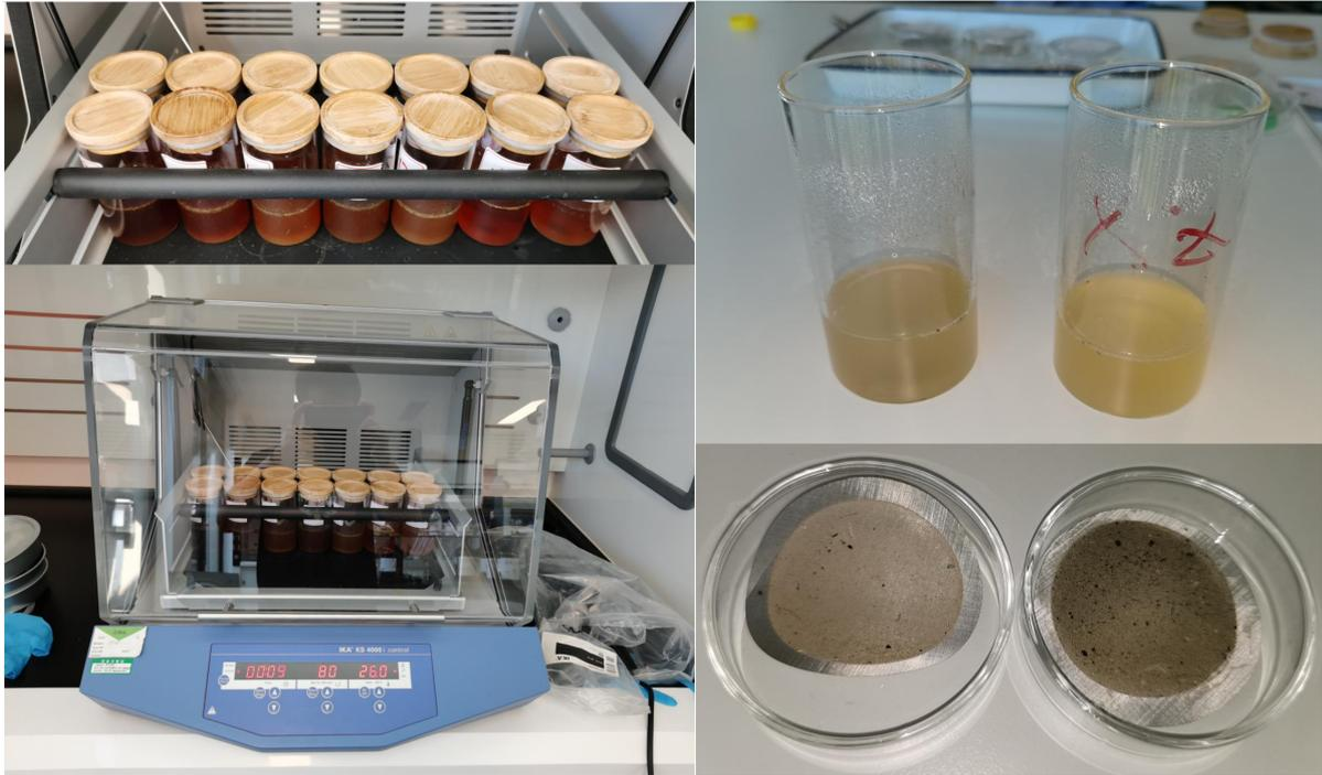
图 5.6-2 不经过预消解的样品消解液及过滤样品（泥沙较多）
