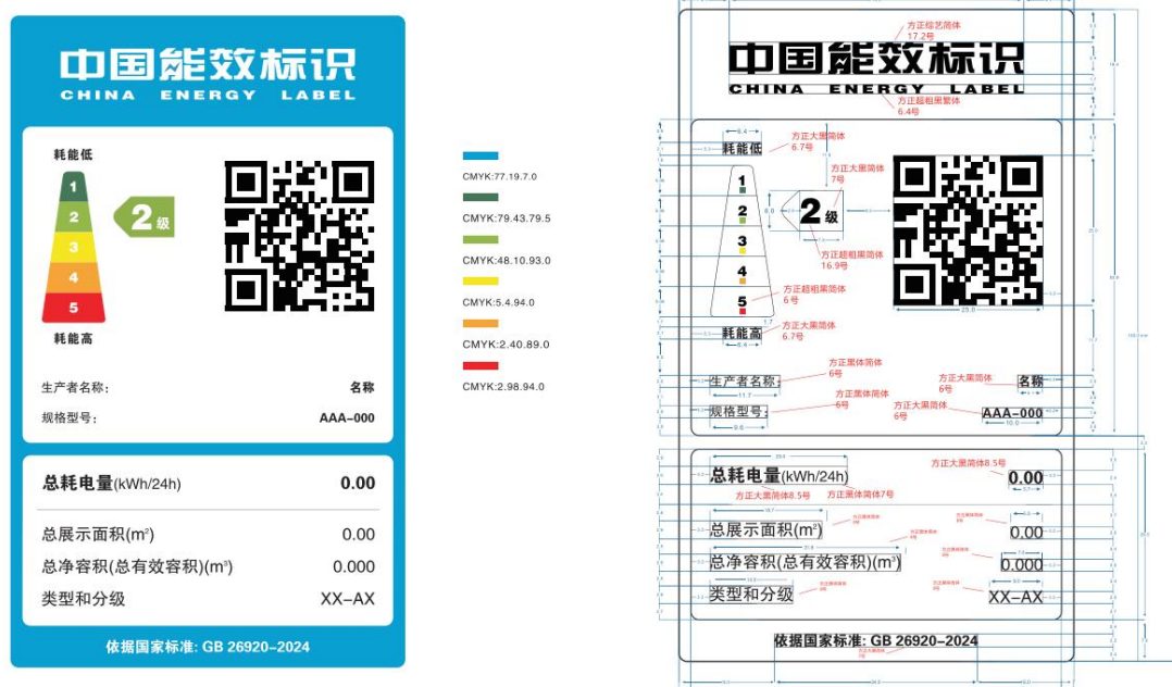
图 1-1 远置式商用冷柜能效标识样式示例
