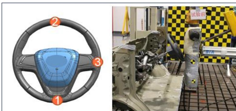
图17 人体模块试验
