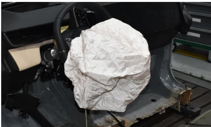
图 12 试验气囊展开图
