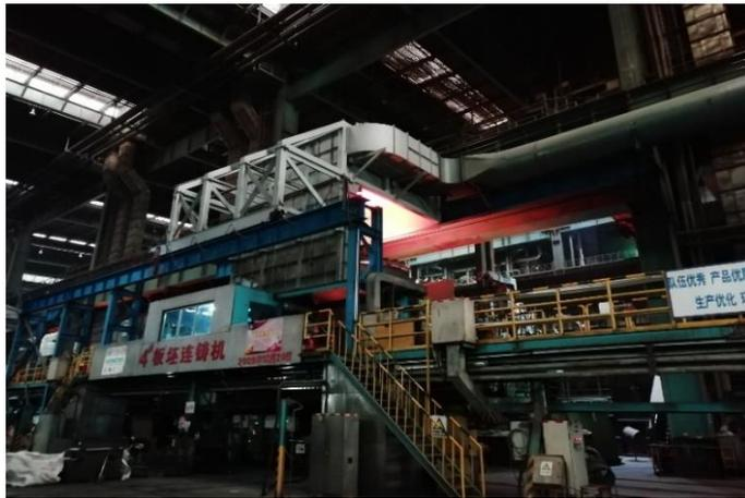
图 4-13 连铸大包旋转台集尘罩与除尘设施
