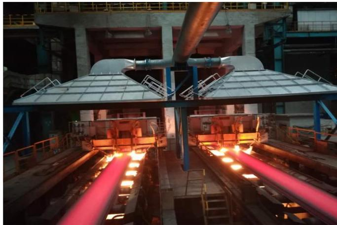
图 4-14 板坯火焰切割集尘罩与除尘设施
