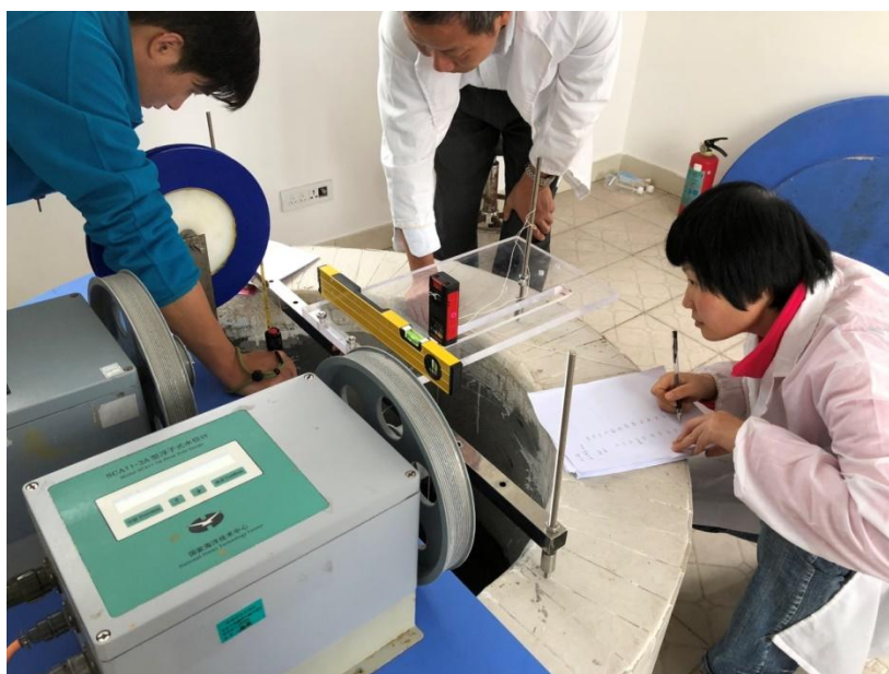
图 4 同时记录潮位仪和激光测距仪读数
