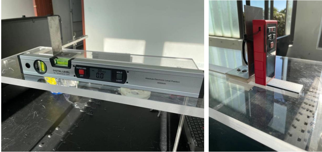
图 2 测量平台安装示意图
