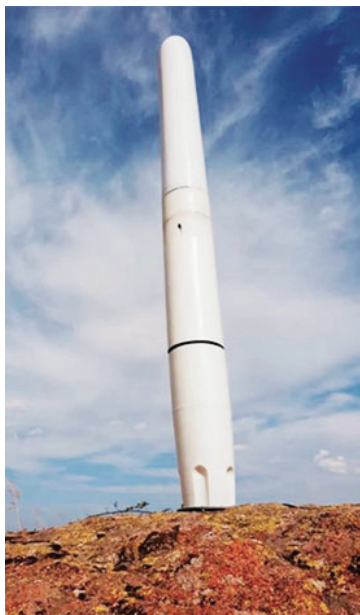
Vortex Tacoma 模型（2.75 米高），位于西班牙阿维拉的 Valle de Ambes
