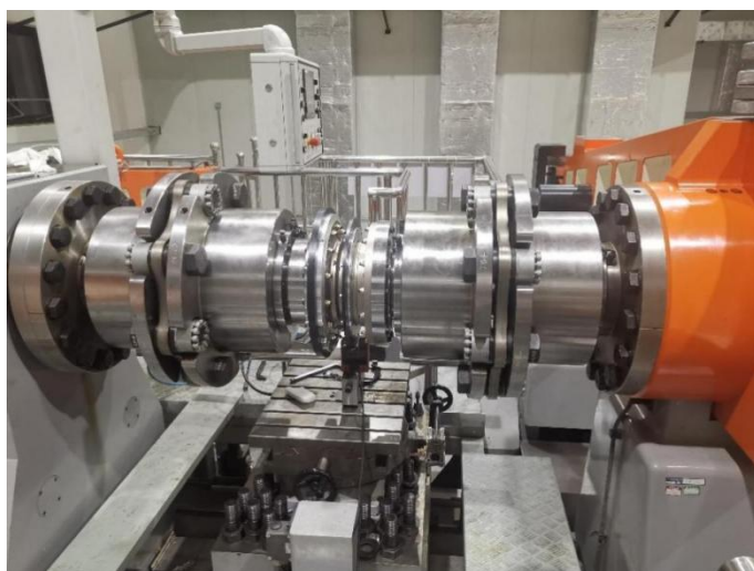
在 200kNm 扭矩标准装置上的校准试验
