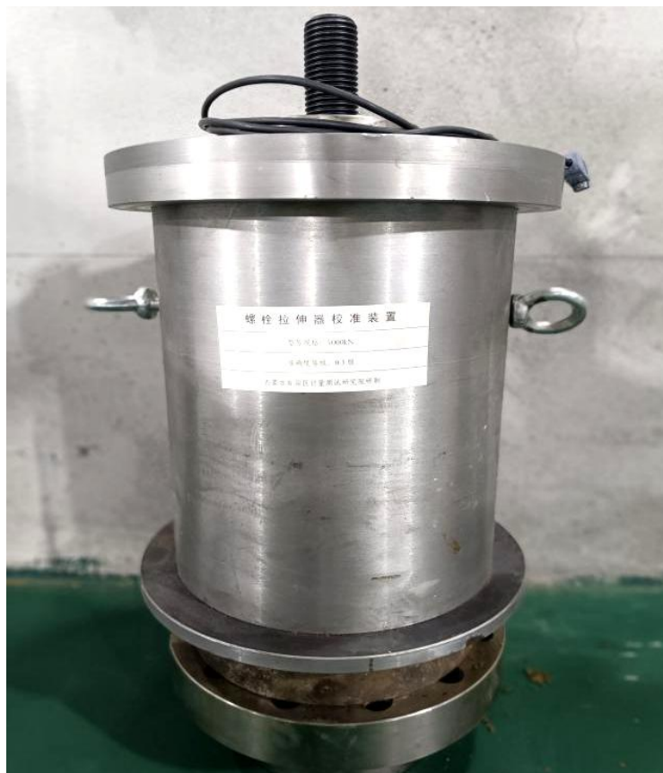
液压螺栓拉伸器校准装置
