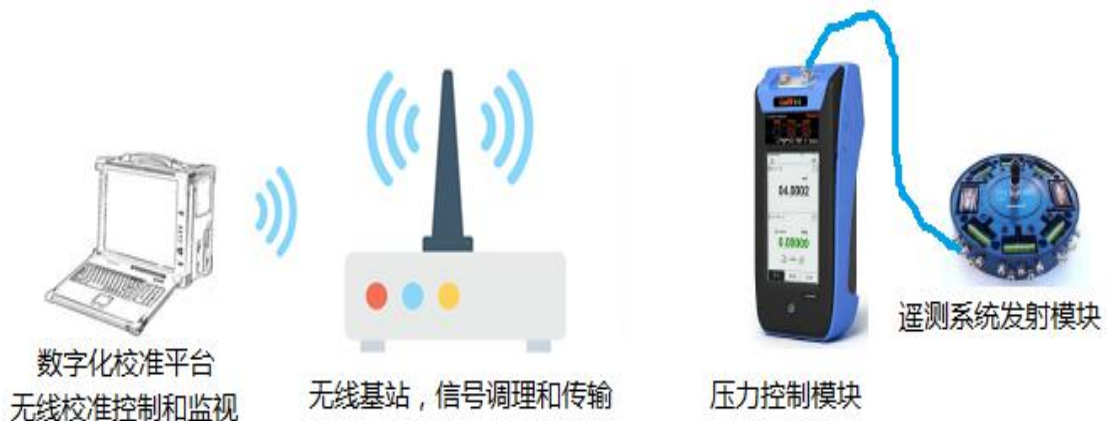
压力远程在线校准逻辑
