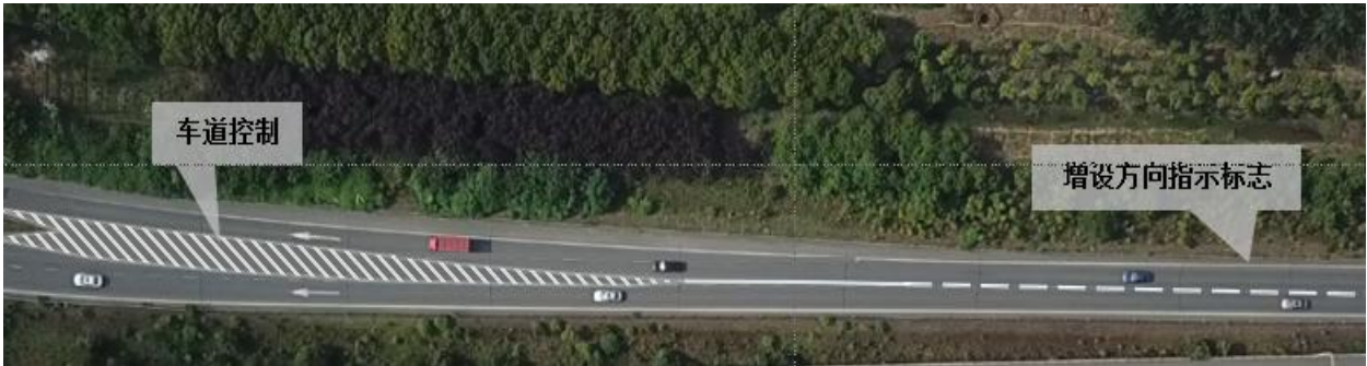
图 F.28 立交分流处车道控制改善示例（流量均衡条件下）
