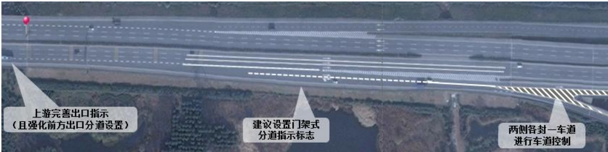
图 F.27 立交连续分流处车道控制改善示例（流量均衡条件下）
