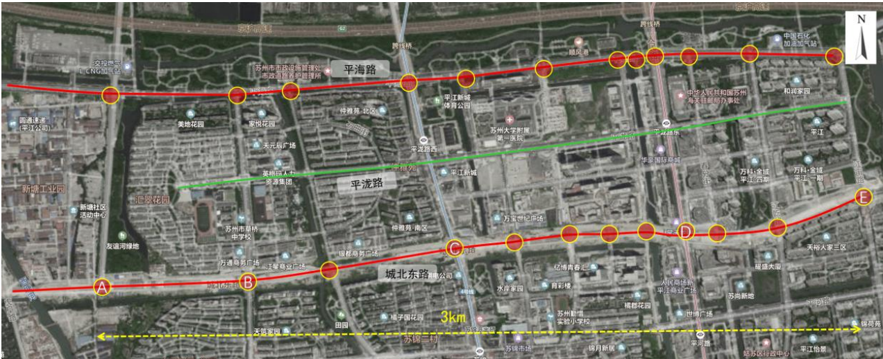
图 F. 32 接入口设置不合理典型问题（接入口密集）
