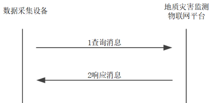
图10 窄带卫星通信状态查询步骤示意图
