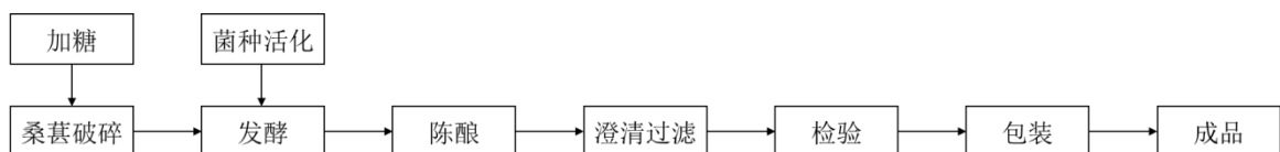
图 1 桑葚发酵酒生产工艺流程图
