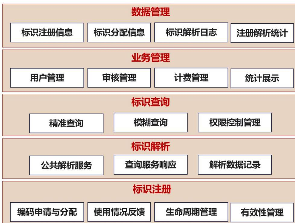
图 5-1 工程机械行业工业互联网标识解析功能架构
