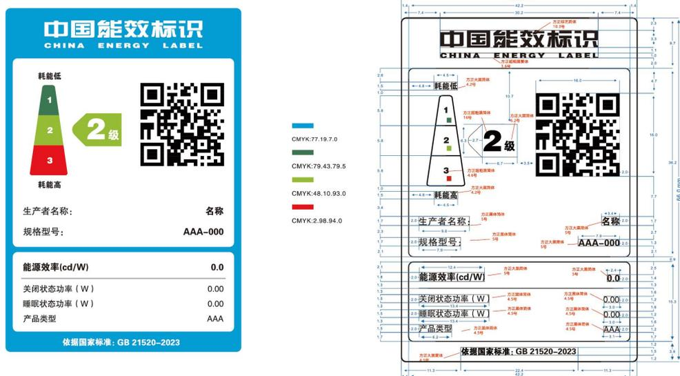
图 1 LCD/OLED 显示器能源效率标识样式示例
