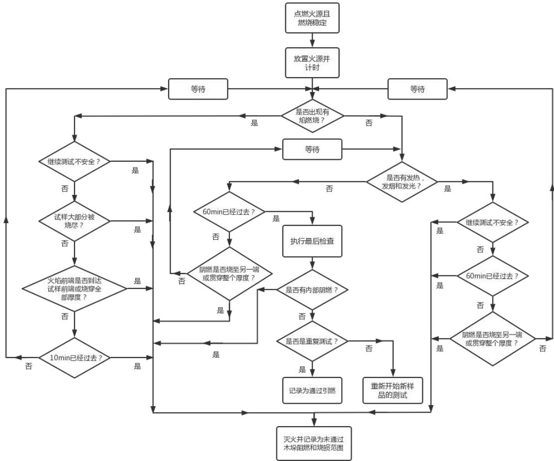
图 C.2 木垛引燃试验流程图
