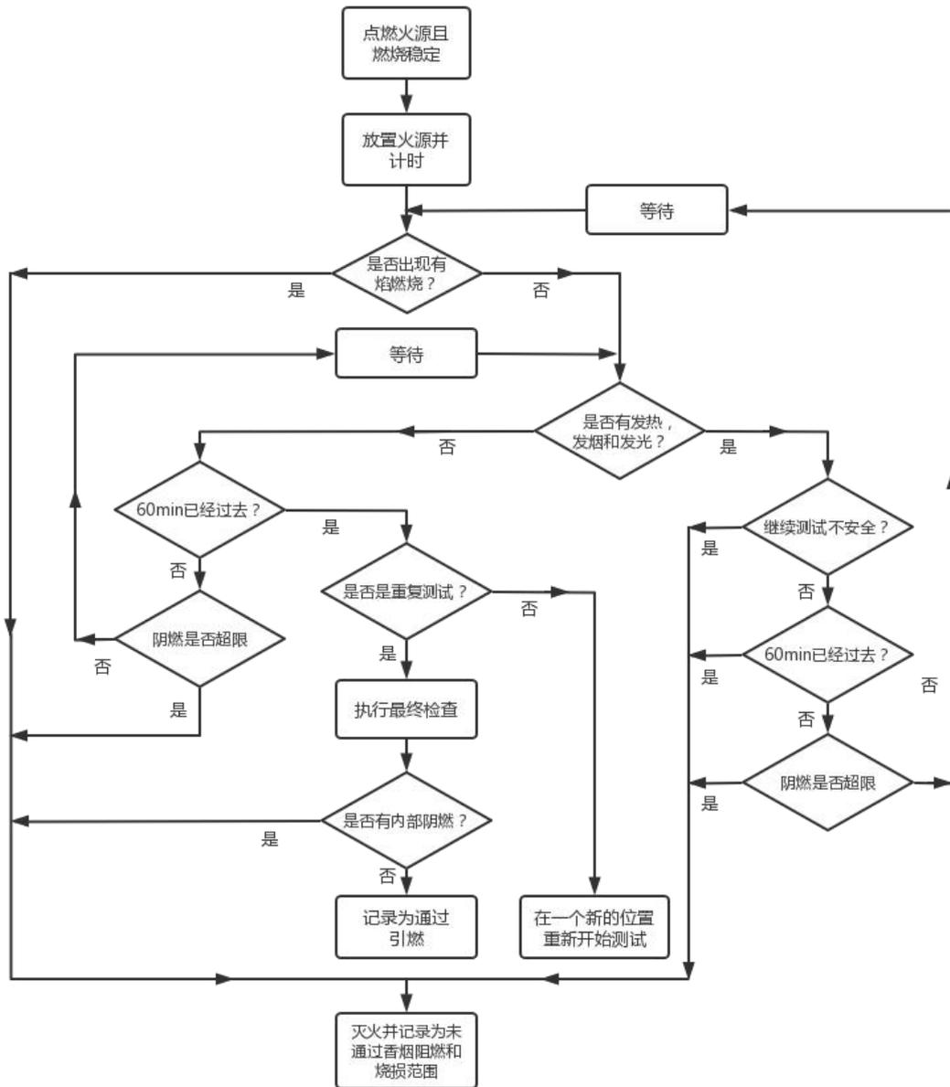
图 A. 1 香烟引燃试验流程图
