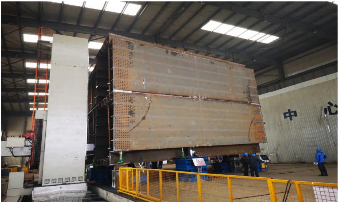
钢塔节段超大断面加工二次接刀
